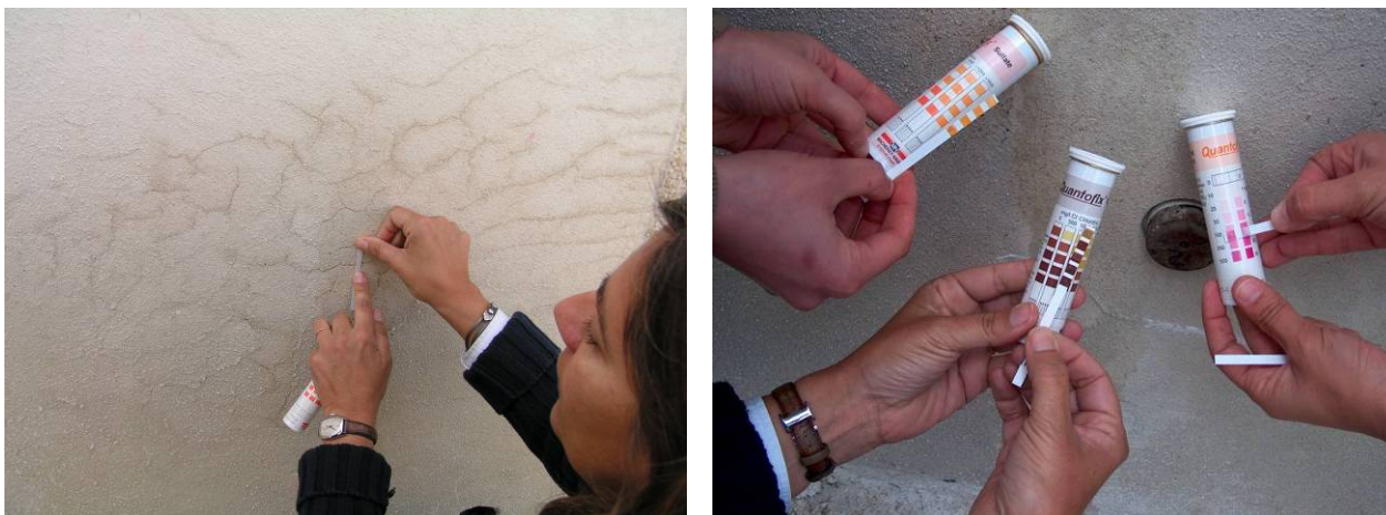
Fig. 10 – Ensaio de identificação de sais solúveis: sulfatos, cloretos, nitritos e nitratos
