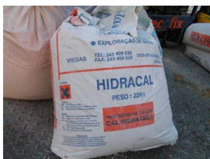
Fig. 5 - Saco de cal aérea hidratada – 22 kg
