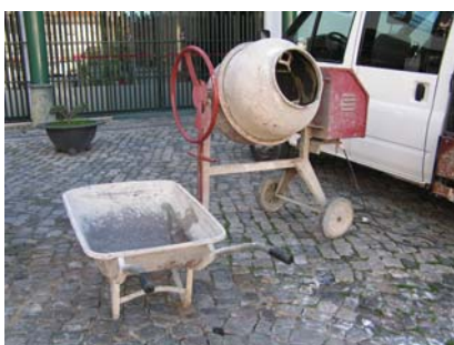
Fig. 1 - Betoneira utilizada para amassadura das argamassas
