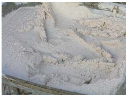
Fig. 9 - Pormenor do aspecto visual da argamassa de cimento branco, cal e areia (tipo A)
