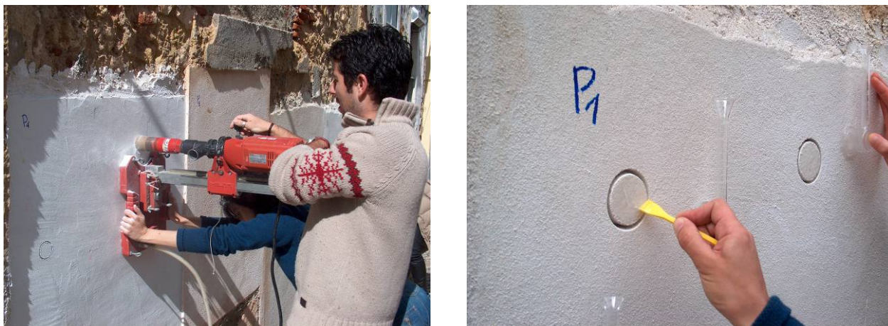
Fig. 14 – Ensaio de aderência: execução da carote; aplicação de cola para colagem da pastilha
