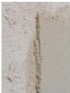
Fig. 15 - Terceira camada do painel 1 - 4-5 mm de espessura
