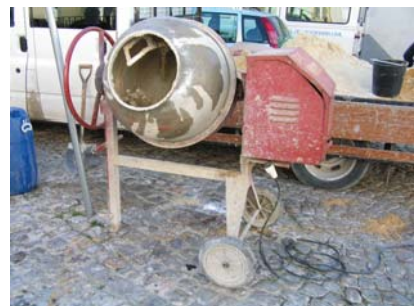
Fig. 6 - Betoneira utilizada para amassadura
