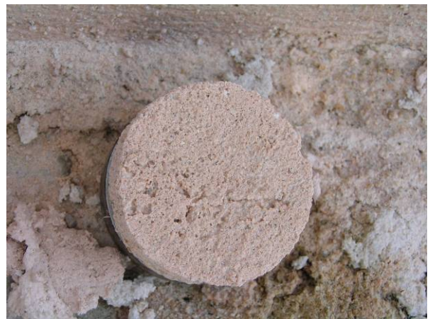
Fig. 15 – Ensaio de aderência: pastilha colada; arrancamento; aspecto do revestimento e da pastilha no caso de rotura coesiva no seio do revestimento (tipo B)
