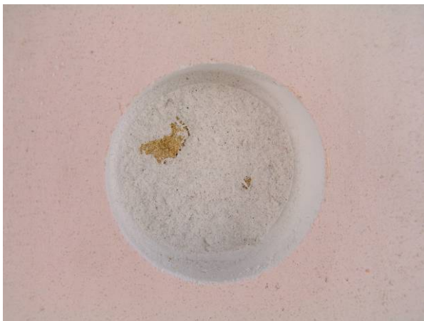
Fig. 15 – Ensaio de aderência: pastilha colada; arrancamento; aspecto do revestimento e da pastilha no caso de rotura coesiva no seio do revestimento (tipo B)
