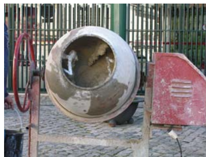
Fig. 41 - Início da execução da segunda camada de revestimento da argamassa tipo A na betoneira
