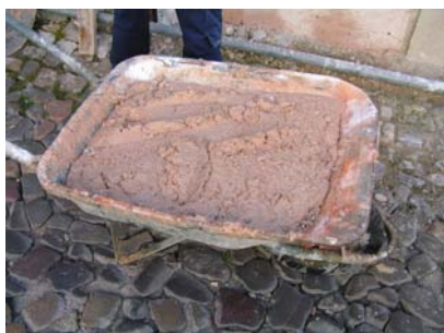
Fig. 50 - Aspecto final da argamassa tipo C
