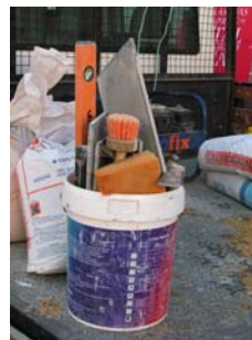
Fig. 12 - Várias ferramentas: talochas, escova, esponja, nível, colher de pedreiro
