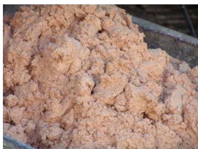
Fig. 29 - Início da execução da argamassa tipo C, de traço 1:0,5:2,5 (metacaulino, cal e areia grossa e fina)
