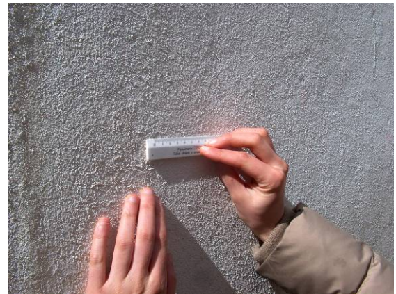
Fig. 8 – Ensaio de choque de esfera. Mossa provocada pela esfera. Medição do diâmetro da massa
